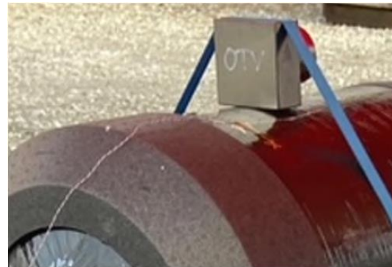
„Magnetfixierung“ des innenliegenden Sensors
